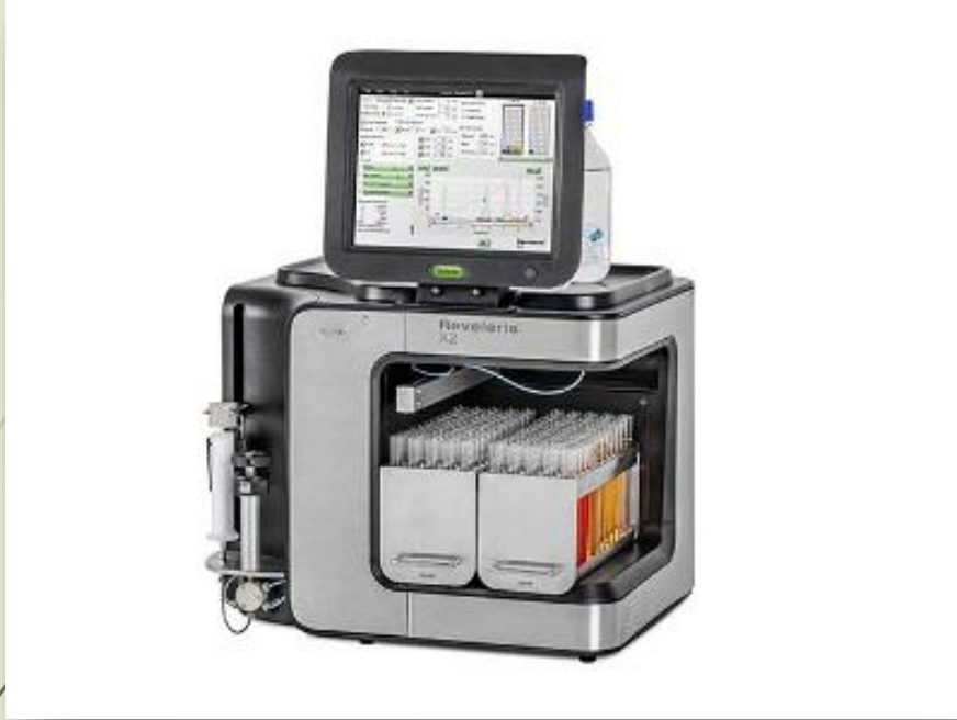
System Reveleris do prowadzenia częściowo zautomatyzowanej chromatografii ciekowej
