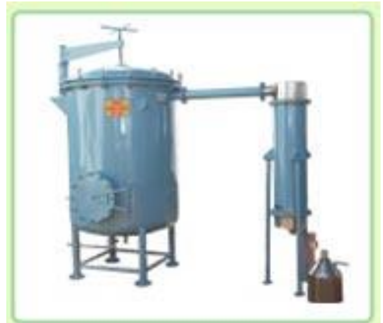
Destylacja z parą wodną: 1 — kocioł; 2 -- doprowadzenie pary wodnej przez bełkotkę; 3 — chłodnica; 4 — flaszka fiorentyńska; 5 -- odbieralniki.
