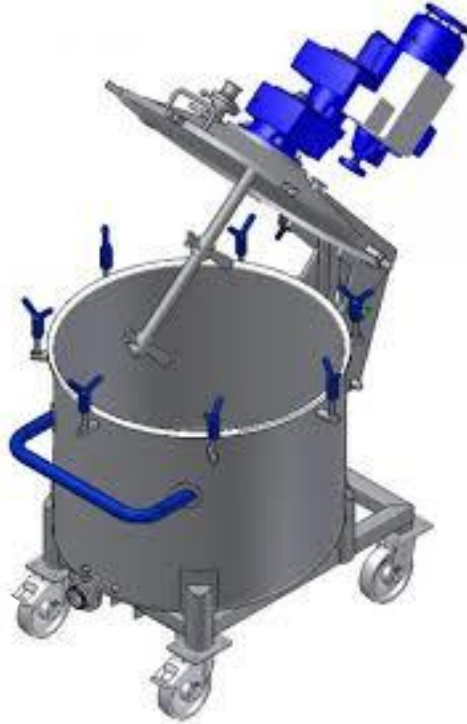
Reaktor uniwersalny Z mieszadłem śmigłowym
